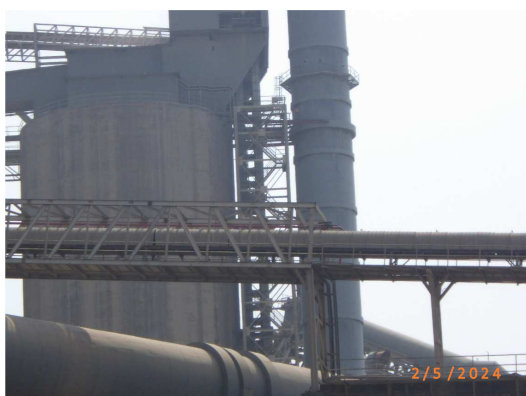
รูปที่ 2-5 Drag chain ลำเลียงฝุ่นจาก Dust Settling Chamber ในระบบปิด
